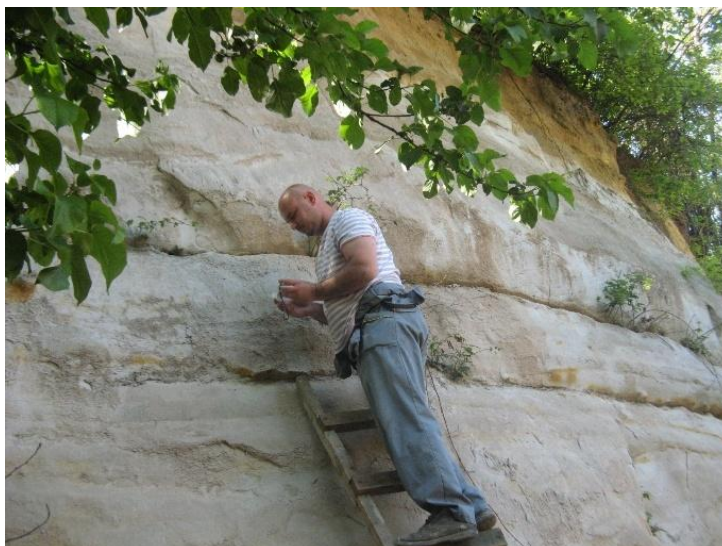
Slika 4. Mjerenje elemenata pada slojeva - zapadna kosina. (Foto A. Čomić, 2011)
