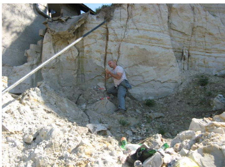
Slika 5. Mjerenje elemenata pada pukotina u u zoni ožiljka odrona. (Foto A. Čomić, 2011).
