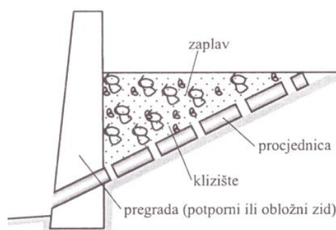
Slika 8. Saniranje klizišta u okviru uređenja bujice pomoću bujične pregrade
