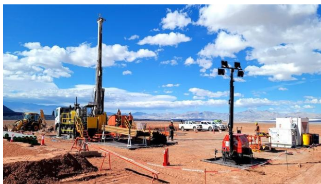
Slika 13. Bušotinska direktna eksploatacija litijuma na Kachi Lithium Brine Project kod Catamarca, Argentina
