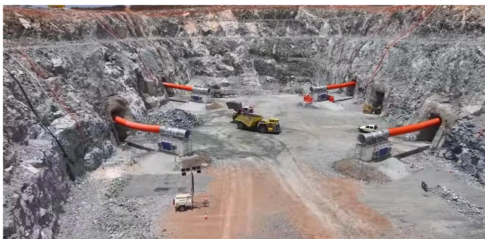
Slika 9. Kombinacija podzemne i površinske eksploatacije sa otvaranjem podzemnih prostorija sa nivoa dna kratera površinskog kopa u Kathleen Valley, Australija
