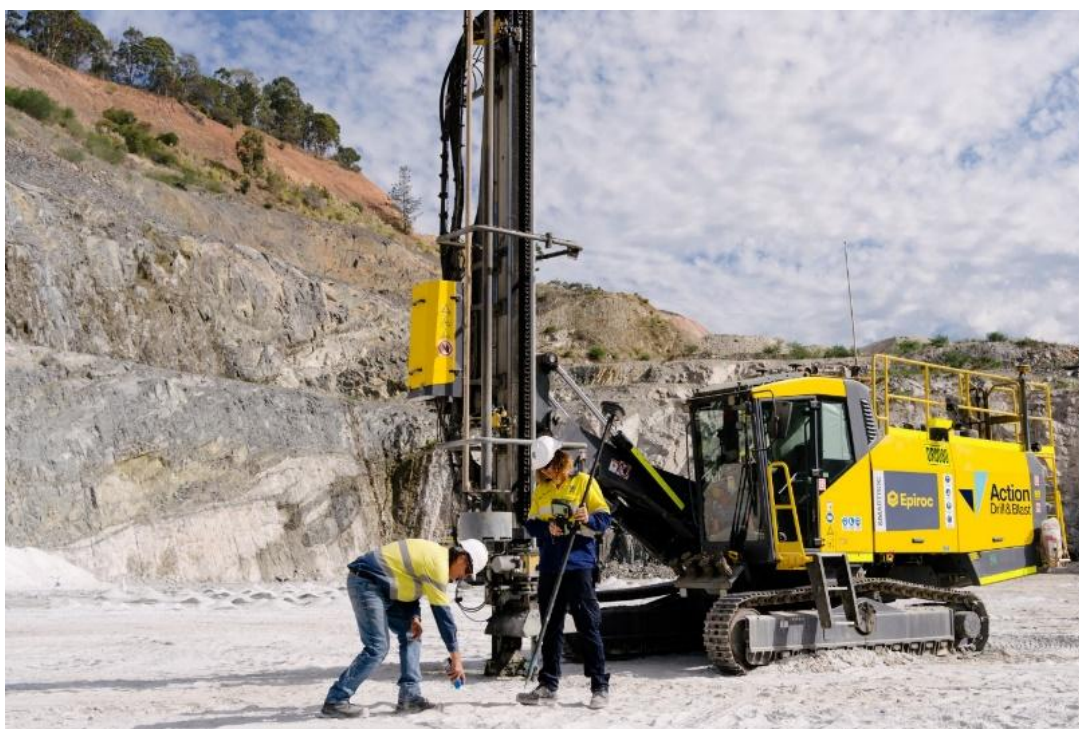
Slika 3. Izbušene minske bušotine pripremljene za punjenje eksplozivom na Talison Lithium's Greenbushes u Australiji
