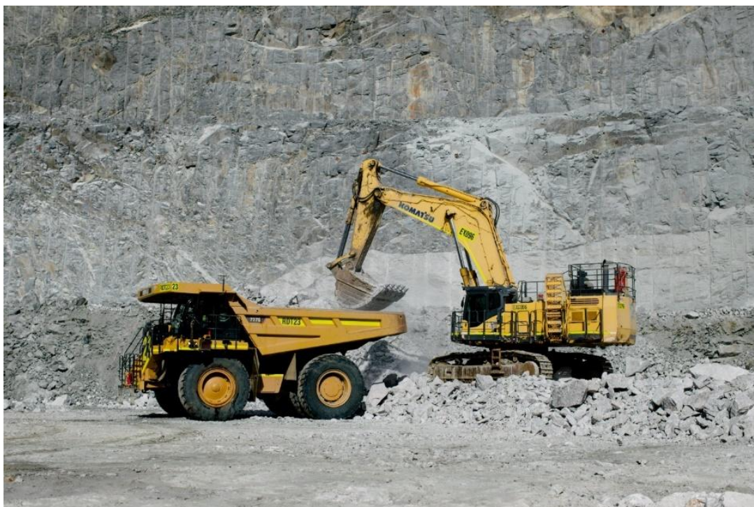
Slika 2. Utovar rude litijuma hidrauličnim bagerom kašikarom u kamion na Talison Lithium's Greenbushes u Australiji
