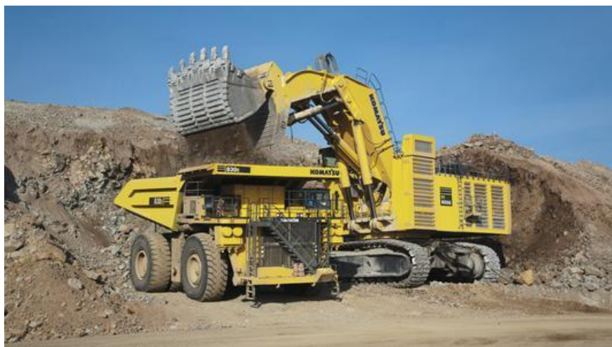
Slika 2. Utovar materijala hidrauličnim bagerom sa rasklopnom kašikom u kamion
