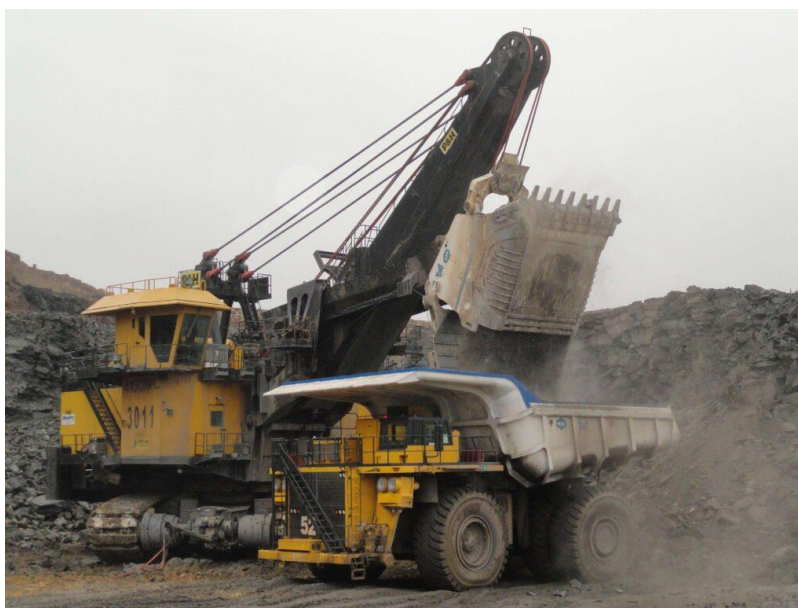
Slika 5. Utovar materijala užetnim bagerom kašikarom u kamion
