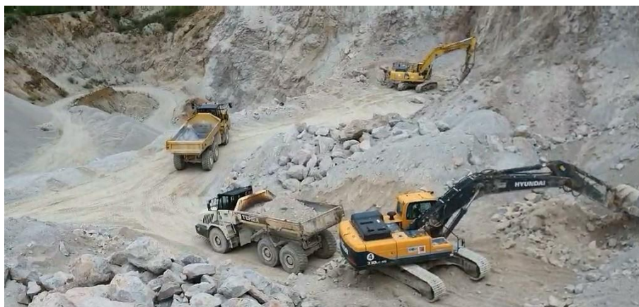
Slika 4. Utovar materijala nakon provedenog miniranja na etaži
